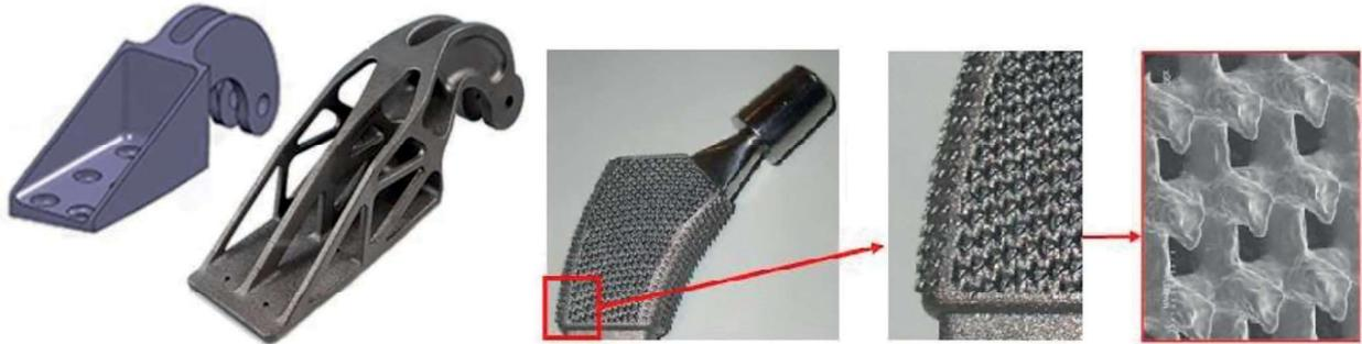
Figure 2 : à gauche : optimisation topologique d'un bracket sur AIRBUS A320 ; à droite : prothèse de hanche avec structure lattice<sup>(2)</sup>
